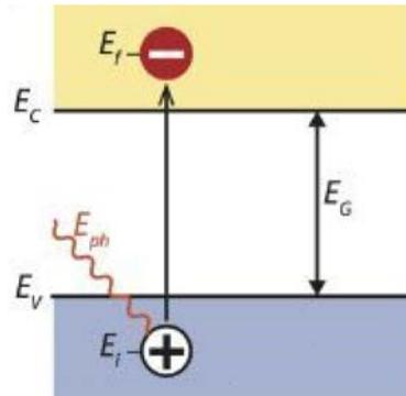
Figura 5. Generación de un par electrón-hueco. Fuente: Solar Energy. The physics and engineering of photovoltaic conversion technologies and systems
