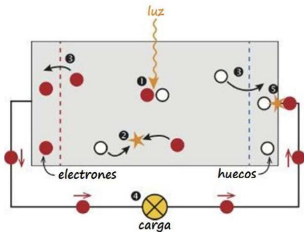
1. Absorción del fotón que permite la generación del par electrón-hueco.
