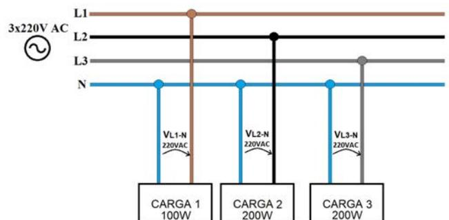
Figura 1. Sistema de conexión eléctrica domiciliar con cargas
