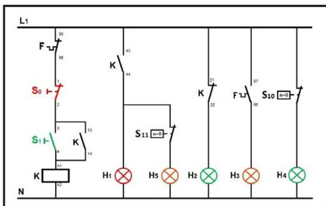
Figura 3- Circuito de señalización incluyendo sensado de movimiento.
