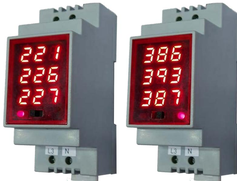
El voltímetro 5FPLDV-01 de Vefben permite visualizar los distintos parámetros simplemente cambiando la posición de un selector.
