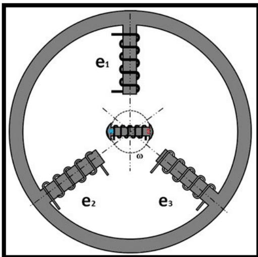
Figura 5- Generador trifásico
