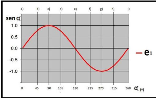
Figura 3- Forma de la onda de fem generada
