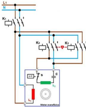
Un motor monofásico consta de dos bobinados, uno de marcha (L1 en color rojo en la figura) y otro de arranque (L2 en color verde en la figura); la inversión de marcha se logra invirtiendo la alimentación en uno de los dos bobinados. Por eso, para poder invertir el sentido de marcha de un motor monofásico, es necesario tener accesibles a los dos terminales de los dos bobinados.
