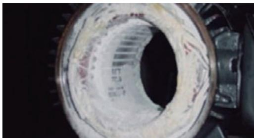
Figura 6. Exceso de contaminación interna.
