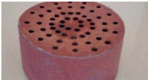
Figura 5. Cubre ventilador mal construido.
