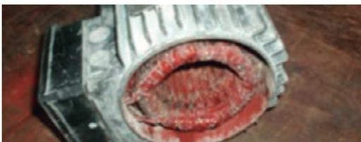
Figura 4. Exceso de contaminantes o múltiples capas de pintura.
