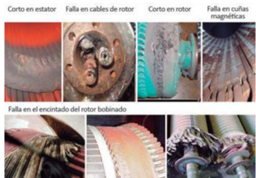
Figura 4. Fallas eléctricas en aerogeneradores.
