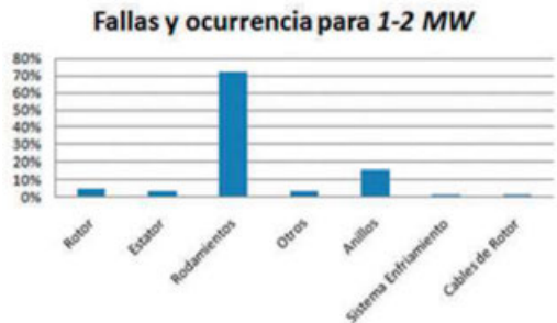
Figura 3. Fallas más comunes en aerogeneradores 1 a 2 MW.
